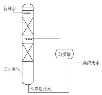
图 5.2-1 脲醛树脂生产工艺废气处理措施流程
