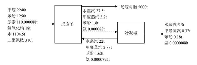
图 2.2-12 酚醛树脂生产线总物料平衡图 单位 t/a
