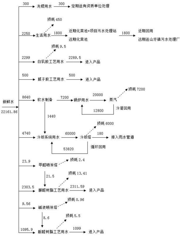
图 2.2-17 项目水平衡图 (m³/a)
