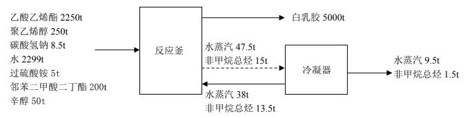
图 2.2-13 白乳胶生产线总物料平衡图 单位 t/a
