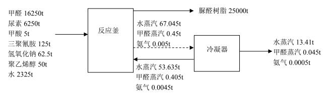
图 2.2-11 脲醛树脂生产线总物料平衡图 单位 t/a
