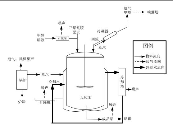
图 2.2-2 脲醛树脂生产设备及产污环节示意图
