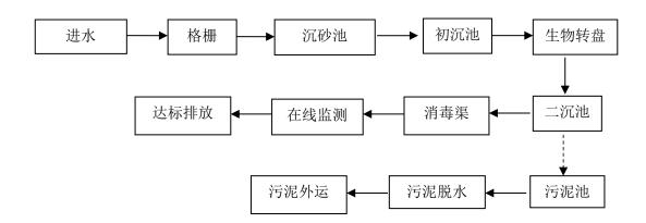
图 3.5-1 扶绥县山圩镇污水处理厂污水处理工艺流程示意图
