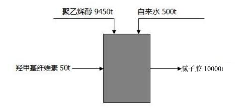
图 2.2-14 腻子胶生产线总物料平衡图 单位 t/a
