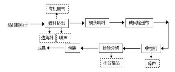
图 2.2.10 热熔胶膜生产工艺流程及产污节点图
