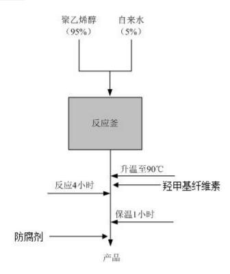
图 2.3-7 腻子胶生产工艺流程图
