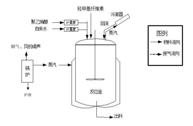
图 2.3-8 腻子胶生产设备及产污环节示意图
