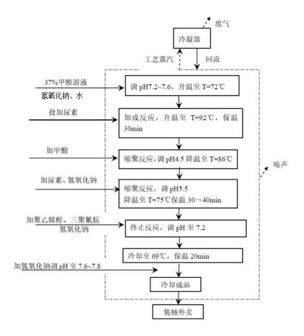
图 2.2-1 脲醛树脂生产工艺流程简图
