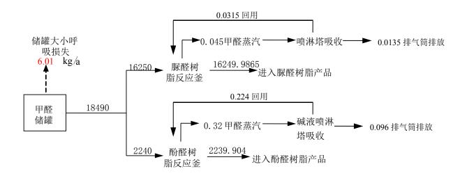
图 2.2-18 本项目甲醛物料平衡图 单位 t/a
