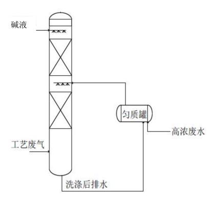
图 5.2-2 酚醛树脂生产工艺废气处理措施流程
