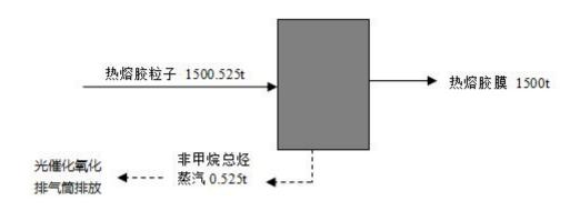
图 2.2-16 热熔胶膜生产线总物料平衡图 单位 t/a
