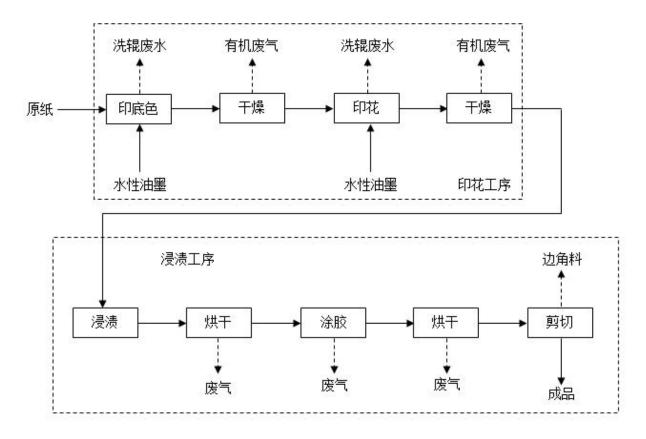
图 2.2-9 浸渍纸生产工艺流程及产污节点图
