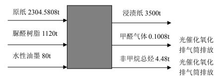
图 2.2-15 浸渍纸生产线总物料平衡图 单位 t/a
