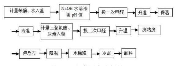
图 2.2-3 酚醛树脂生产工艺流程图
