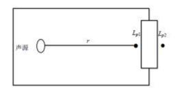
图 4.2-5 室内声源等效为室外声源图例
