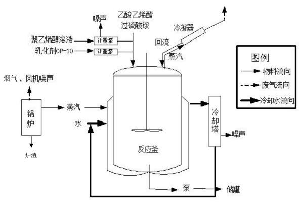
图 2.2-6 白乳胶生产设备及产污环节示意图
