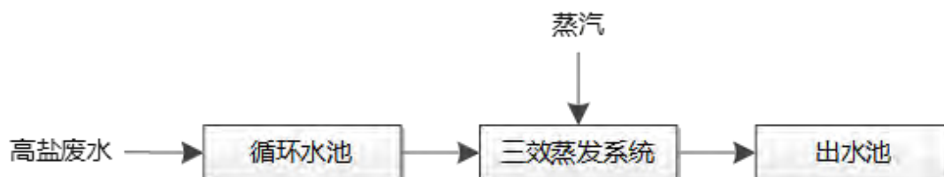
图2.1-25 焚烧处理系统废水处理工艺流程
